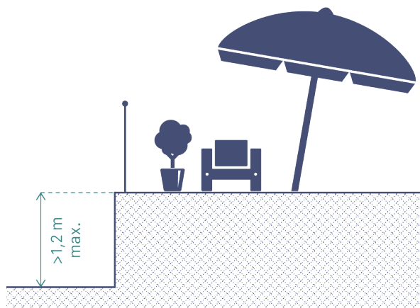
Garde-corps dans les aménagements extérieurs
