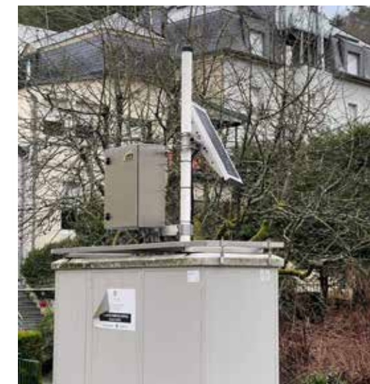
Solaranlag fir den Hydrometer z'alimentéieren
